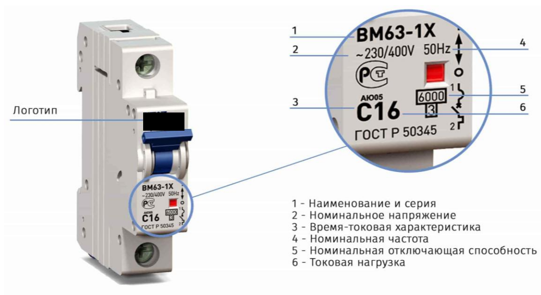
Рисунок 2. Пример маркировки АВ
