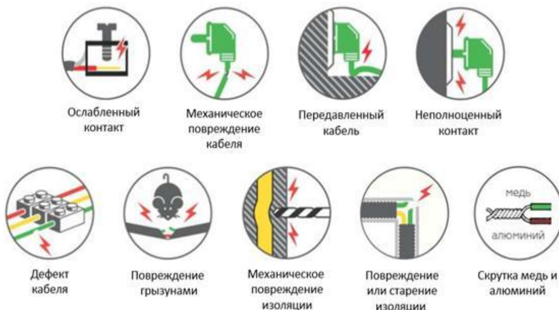
Рисунок 6. Возможные причины искрения в электропроводке
