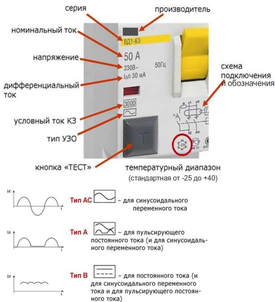
Рисунок 5. Маркировка УДТ
