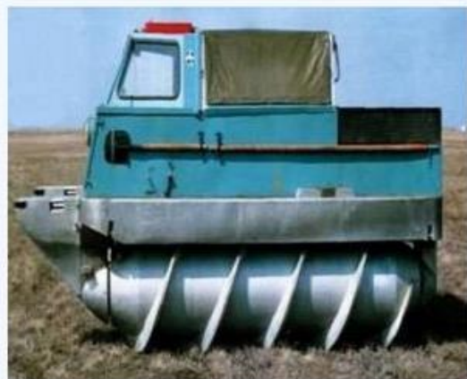
Использование шнека для передвижения
